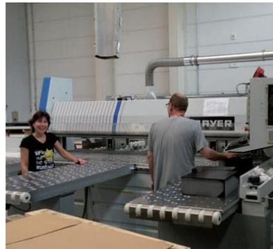
Seit April haben wir eine neue **MAYER CNC-Plattenaufteilsäge** in unserem ServiceCenter installiert. Diese Anlage kann Plattenmaterialien bis zu einer Dicke von 200 mm verarbeiten. Das äußerst stabile und präzise Maschinenkonzept sowie die intelligente Aufteiltechnik der
