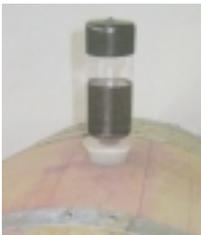
Um während des Gärungsprozesses von Weinen die Sauerstoffzufuhr in Holzfässern zu unterbinden, bedient man sich der Hilfe eines Vakuum-Langzeit-Füllstandsanzeigers. Hierzu ist der Einsatz eines Werkstoffes mit Lebensmittelzulassung, einer guten chemischen Beständigkeit und hoher Transparenz notwendig. Diese Voraussetzungen
