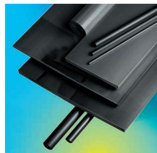
Unser **GEHR PP-30GF®**, welches mit **30% Glasfasern verstärkt** ist, zeichnet sich durch eine optimierte Steifigkeit, sehr gute Festigkeit sowie eine gesteigerte Dimensionsstabilität aus. Die hohe Wärmeformbeständigkeit HDT/B mit +155 °C liegt im ähnlichen Bereich wie **GEHR PA 6.6-30GF®** und erschließt somit viele An-
