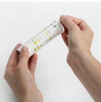
Ablesen des Ergebnisses durch Abgleich des Teststreifens mit der Farbvergleichstabelle.
